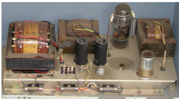
foto voedingsblok op vloerplaat
