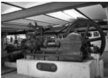
foto 4. Ammoniakcompressor 'Phoenix' uit 1930
