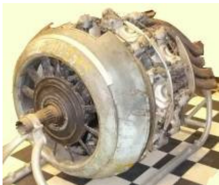
Foto A.B Een originele BMW 810 motor uit de verzameling van het Thermo-Technisch Instituut van de KUL. De voorste ring van de motorbekleding bevat de oliekoeler. Merk op dat deze smaller is dan bij de Chinese dubbele stermotor van de Flug Werk 190.
